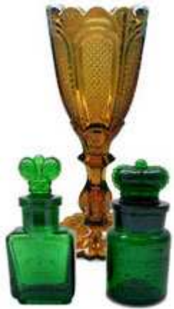
Vidro com Fe(III), ambar, e Fe(III) e BaO, verde.
